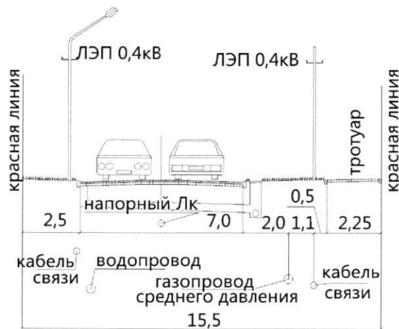
Рисунок 2.Схема поперечного профиля магистральной улицы районного значения (сечение 2-2)
